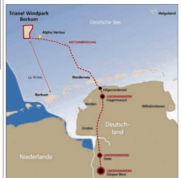
Vom Windpark 45 Kilometer vor Borkum gelangt der Strom über Seekabel und Umspannwerke bis nach Dörpen zur Haupttrasse.
